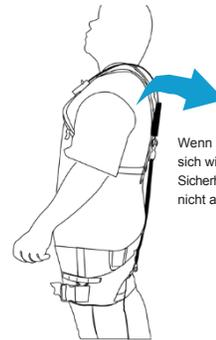
Wenn sich der Anzug nicht ausgerastet anfühlt, stellen Sie sich wieder in eine aufrechte Position. (Dies ist ein Sicherheitsmechanismus, der sicherstellt, dass die Kupplung nicht ausrastet, wenn sie belastet wird.)
