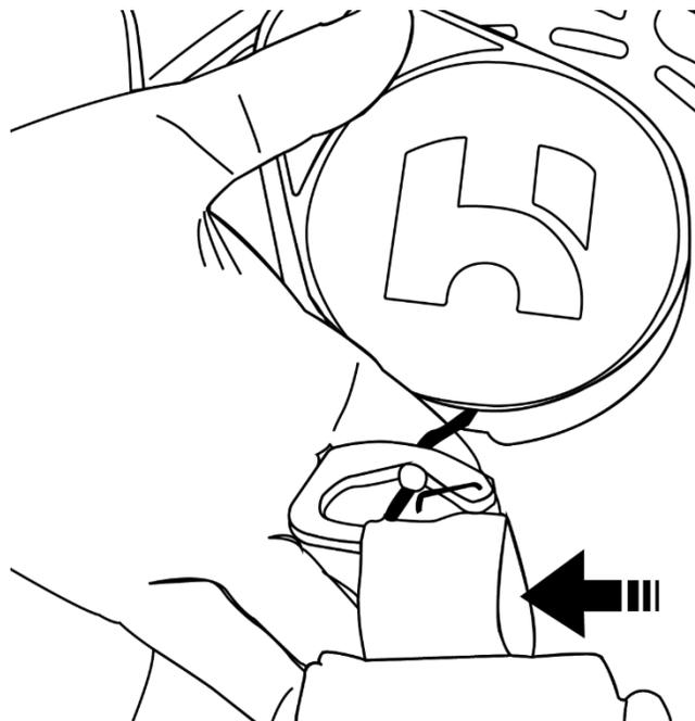
9. Beachten Sie die beschriftete Ausrichtung (links und rechts) der Bänder und Schenkelhülsen. Verbinden Sie jedes Band mit der entsprechenden Oberschenkelmanschette, indem Sie den Verschluss Metallkarabiners an der Unterseite des Bandes öffnen und die Schlaufe an der Oberseite der Oberschenkelmanschette in die Öffnung des Karabiners schieben. Die Öffnung des Metallkarabiners sollte geschlossen sein und nach innen zeigen.
